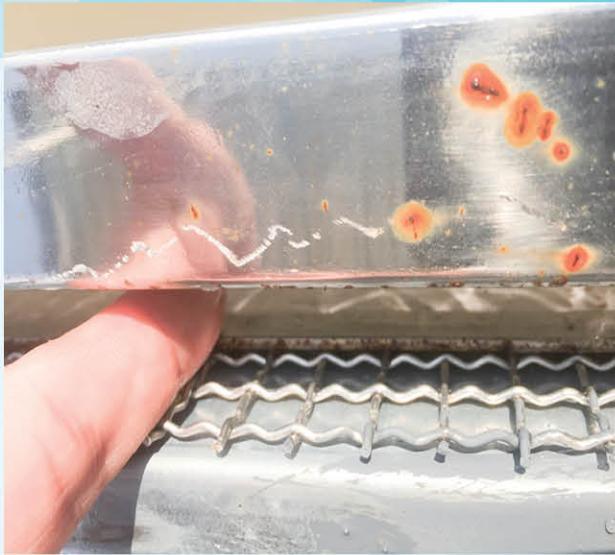
Lưới lồng thiết kế chắc chắn bằng INOX với cỡ mắt lưới < 8 mm
